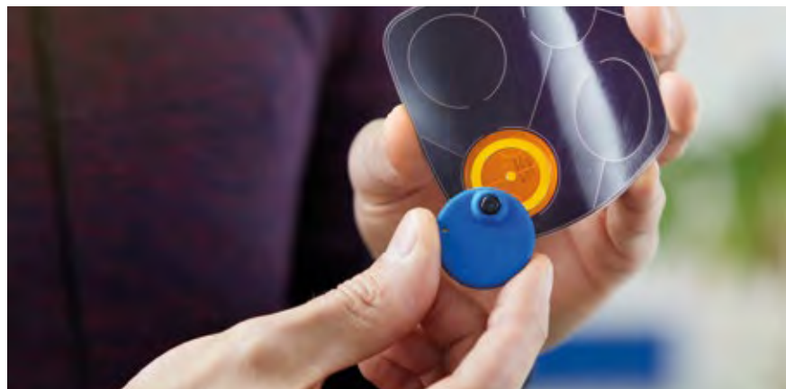
Les capteurs (ici WITNESS, équipé pour la prise d'images) doivent être autonomes, pourvus de cellules solaires, et capables de trier les données pertinentes pour éviter qu'ils n'ajoutent aux besoins énergétiques globaux.
