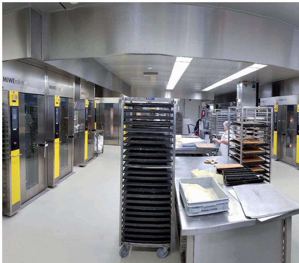
Die alten Backöfen wurden durch neue, energieeffiziente Öfen mit einem grösseren Wärmespeicher ersetzt.
